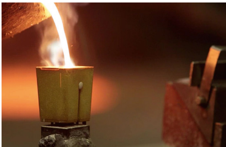
Recolha de uma amostra de fundição para garantia de qualidade
