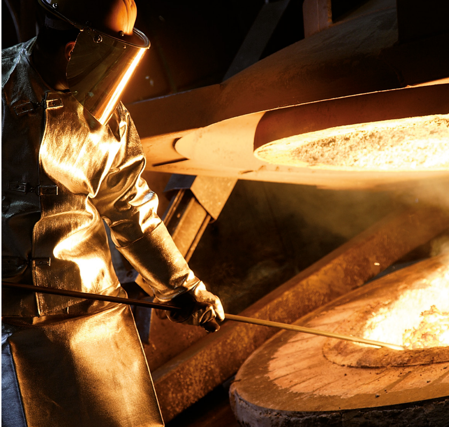
Amostragem do material fundido para análise espectral
