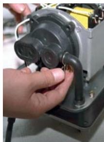
9. Retirar manguera de conexión (13) y cuerpo de la válvula (12), deslizar la abrazadera de la manguera (14).
