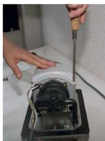
19. Fije la tapa del soporte (5) con tornillos. comprue el funcionamiento del inyector.
