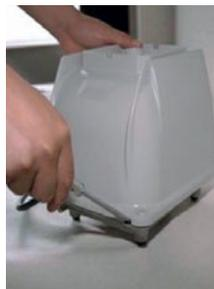
3. Si es difícil de sacar (3) inserte un destornillador entre la bandeja (18) y la cubierta.
