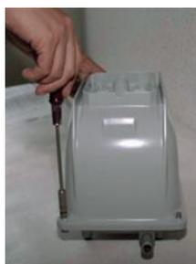
23. Fije la cubierta con tornillos (EL-120: (25), EL-200 y EL-250: (26)) y tuercas (EL-120: (32), EL-200 y EL-250: (33)).
