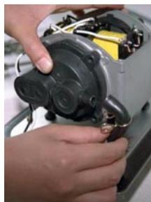
14. Ajustar la nueva caja de la válvula (12) en el lugar de la vieja. Asegurar provisionalmente con tornillos (EL-120: (30), EL-200 y EL-250:(31)). Sustituya la caja de la válvula, el diafragma del otro lado del mismo modo.
