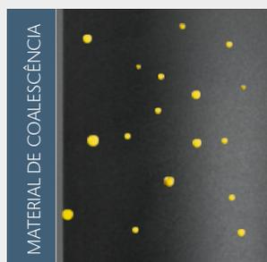
Pequenas gotas de óleo que não são separadas porque têm uma densidade diferente da água, ligam-se com o elemento de coalescência amigo do óleo.
