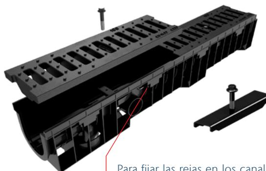
Para fijar las rejas en los canales ACO Xtraline C con anchura interior de 100, 150 y 200 mm, se necesitan una barra y un tornillo cada medio metro de canal. Para fijar la reja en los canales ACO Xtraline C 300, se necesitan 4 tuercas por cada medio metro de canal.
