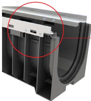
El bastidor de acero tiene una altura de 20 mm y un grosor de 2,5 mm en la zona expuesta al tránsito de vehículos. Sujeta las rejillas y ayuda a una fácil instalación del sistema de canales.
