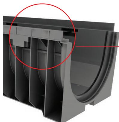
El bastidor HD-PE de 20 mm de altura (35 mm para ACO Xtraline C 300) contiene y limita la reja, haciendo más fácil y cómoda su instalación.
