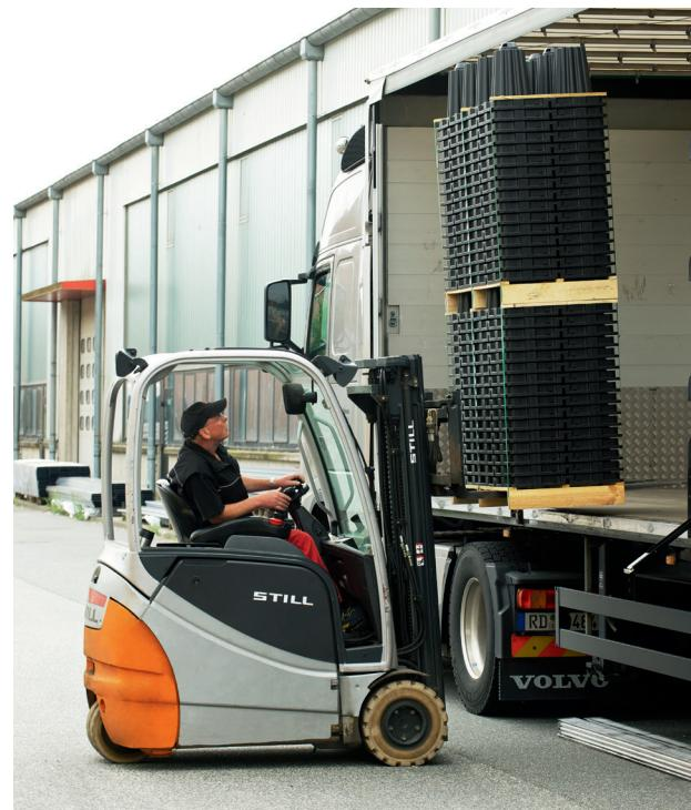
O empilhamento otimizado reduz os custos de transporte. Por exemplo: o projeto A requer um volume de armazenamento de 280 m<sup>3</sup>. Com o Stormbrixx, é possível transportar todas as unidades necessárias num único reboque. Outros sistemas exigiriam até quatro reboques.
